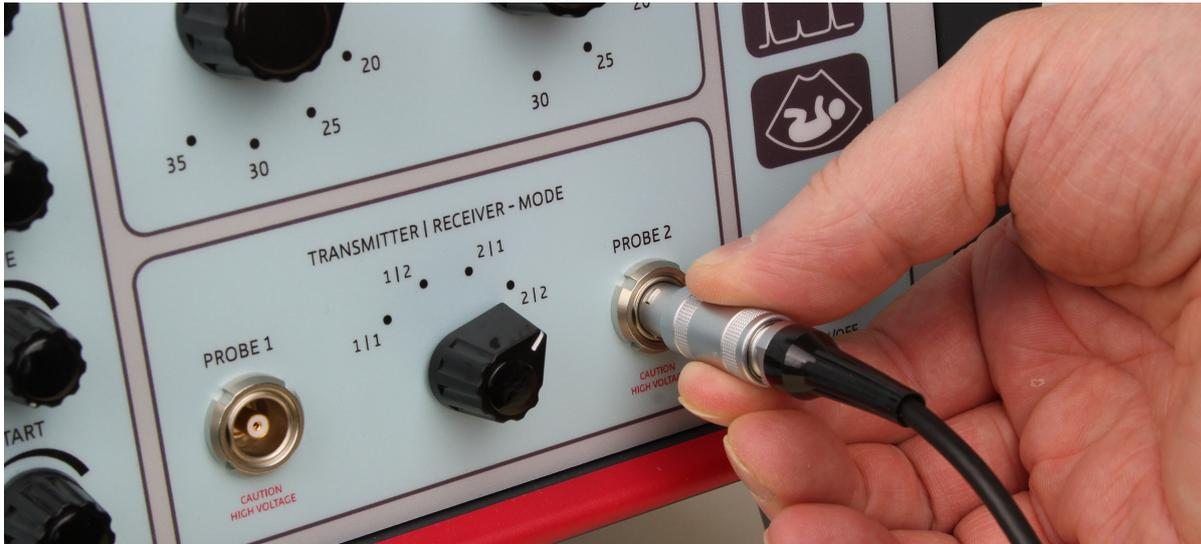
Abb. 11: Anschließen/Abziehen eines Ein-Element-Wandlers an das GS200/GS200i)
